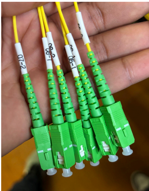
Image 1 : Câbles à fibre optique SC/APC jaunes avec des identifiants spécifiques, garantissant une connectivité stable et de haute qualité.
